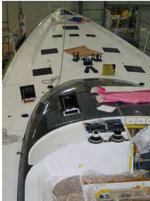
Pose de l'accastillage en cours
